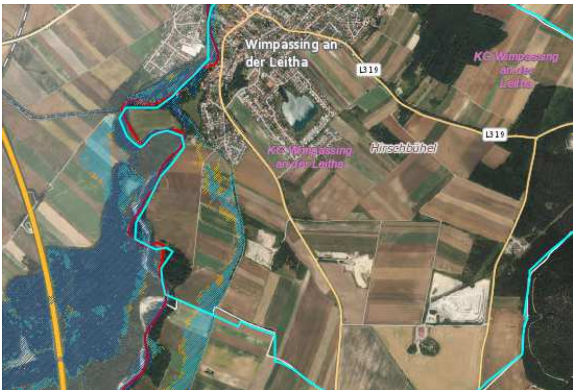
Abbildung 22: Wimpassing, Überflutungsflächen (blau) süd-westlicher Bereich
